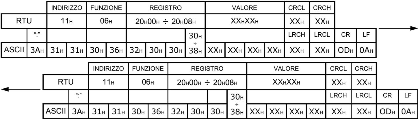
L'unità master (PC/PLC) invia ad un registro (2000<sub>HEX</sub> ÷ 2008<sub>HEX</sub>) corrispondente ad un parametro (PAR00 ÷ PAR08) un valore esadecimale a 2 bytes esadecimale (in MODBUS<sub>RTU</sub>) o 4 bytes ascii (in MODBUS<sub>ASCII</sub>).
